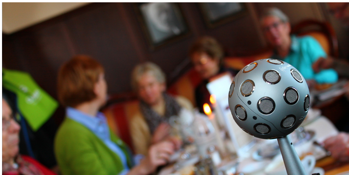
Alltägliche Hörsituationen wurden mit hochwertiger Tontechnik aufgezeichnet und im Wellenfeldsynthese-System für Hörexperimente reproduziert.
